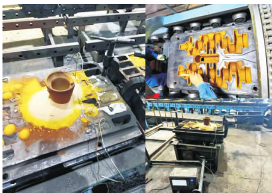
图8 现场热电偶测量布置
