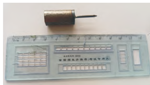
图1 GT35 钢结硬质合金柱宏观形貌
