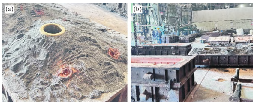
图4 镶铸锤头合箱图:(a) 上砂箱图;(b) 合箱图
