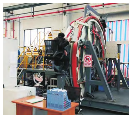
图 3 国产超高速等离子旋转电极(SS-PREP ® )制粉设备(SMT)
