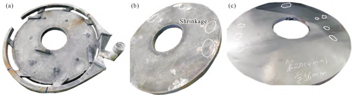
图3 无冒口外圈盖箱进水浇注的研磨盘:(a)落砂后研磨盘形貌;(b)清理后磨盘表面形貌;(c)表面切削2刀去除9 mm后的形貌
