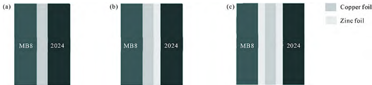
图 14 3 种中间层配置:(a) 单独铜;(b) Cu-Zn 复合中间层;(c) Zn-Cu-Zn 复合中间层 [57]
