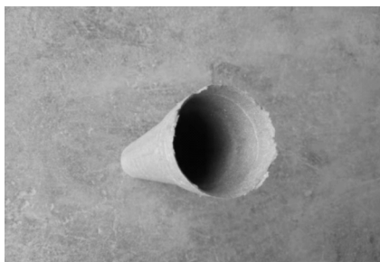
图7 毛边轴向生长 Fig.7 Axial growth of burr
