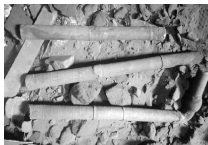
图4 纸质浇道管在某机床件使用,打箱后的浇道
