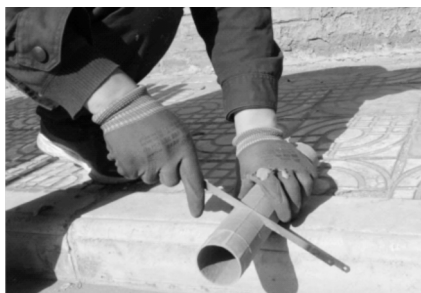
图2 锯条轻易切断纸质浇道管
