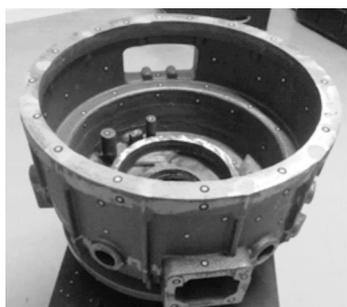
图 19 齿轮室铸件
