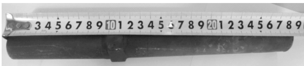
(a)断裂套管整体形貌
