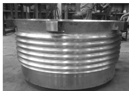
图 15 沟槽没有任何缺陷 Fig.15 No defect in the groove
