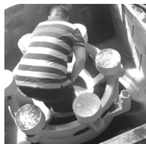
图6 填砂埋型 Fig.6 Sand filled molding
