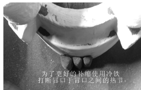
图9 外冷铁的使用 Fig.9 Using of external chiller
