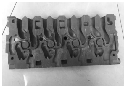
图 4 缸盖铸件解剖照片
