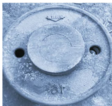
图4 轮毂铸件实物
