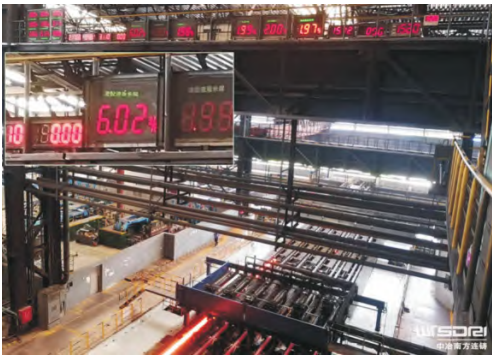
图 10 三钢 3# 方坯连铸机最高拉速可达 6.02 m/min Fig.10 Maximum casting speed of 6.02 m/min for San gangue steel 3# billet caster
