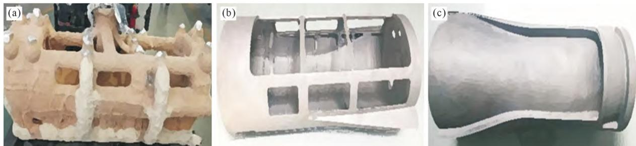
图 8 整体骨架:(a) 浇注型壳;(b, c) 整体铸件正面和背面
