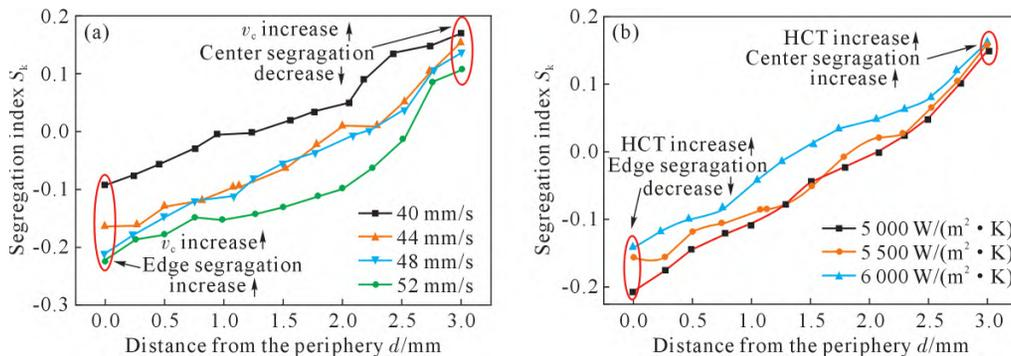
图11 变化偏析指数随距边缘的变化:(a)不同铸造速度;(b)不同传热系数<sup>[55]</sup>
