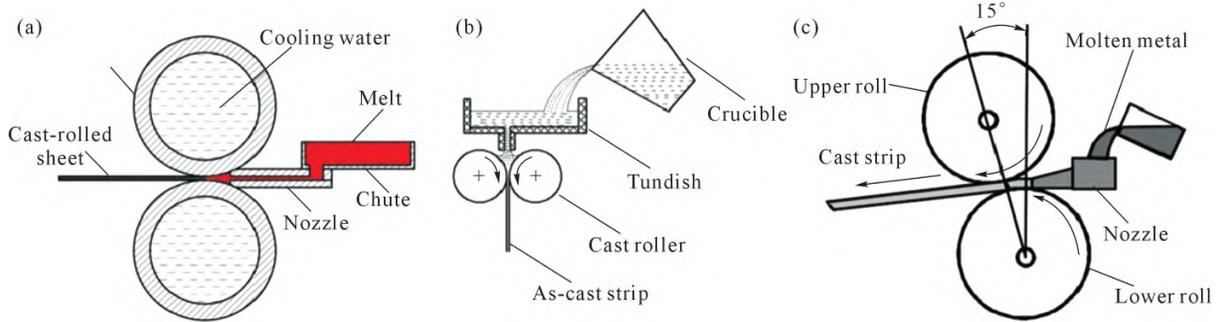
图1 双辊铸轧工艺示意图:(a)水平铸轧;(b)立式铸轧;(c)倾斜式铸轧<sup>[7]</sup>
