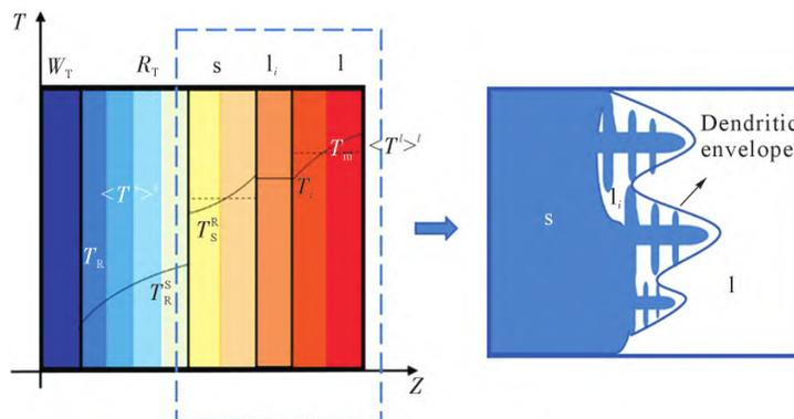
图5 热传输示意图<sup>[23]</sup>
