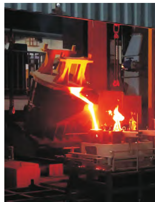
图9 浇注机自动浇注
