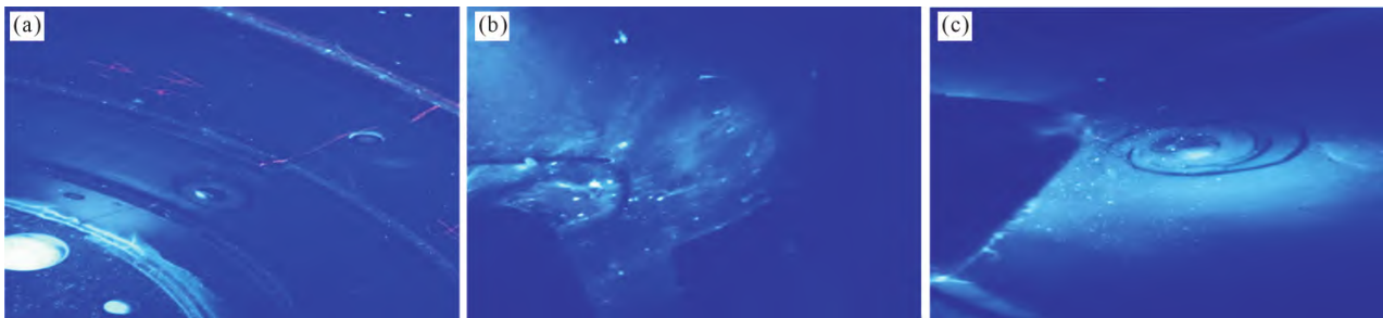
图 12 铸件典型缺陷焊后荧光显示:(a) 腹板穿透;(b) R 角;(c) 厚大区穿透
