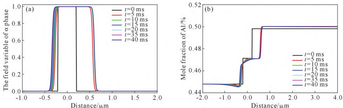
图 4  $T=1760.9 \text{ K}$  下一维包晶转变模拟结果:(a) 相场;(b) 成分场
