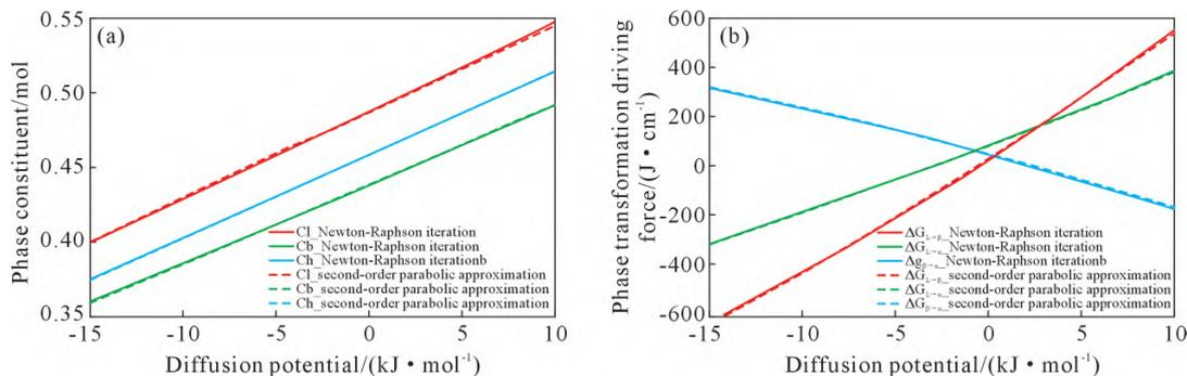
图 3 牛顿-拉夫逊迭代法和二阶抛物线近似算法对比:(a) 相组分;(b) 相变驱动力
