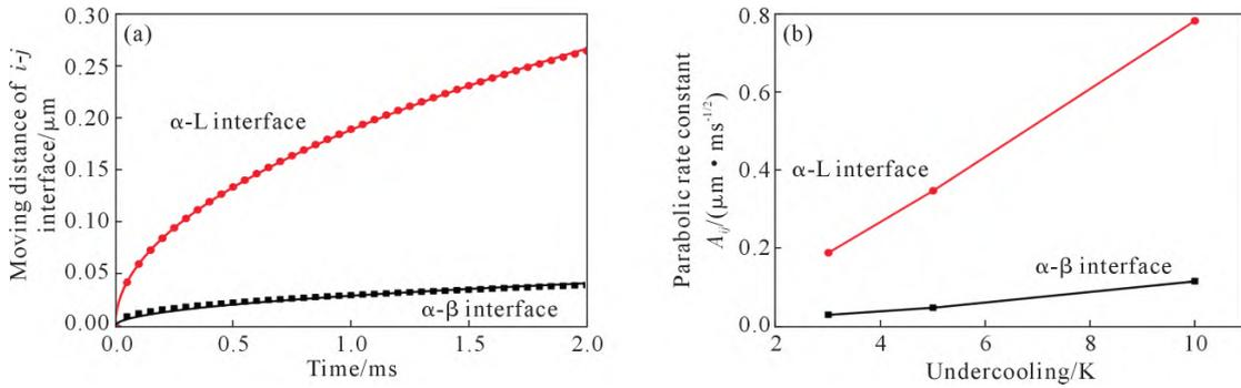
图5 包晶转变过程平界面运动的定量分析:(a)  $T=1760.9\text{ K}$  下各界面移动距离与时间的关系;(b) 各界面抛物线速率常数与过冷度的关系
