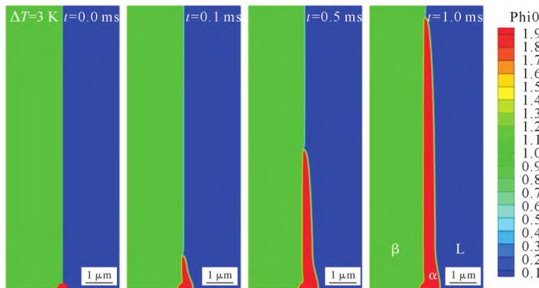
图6  $T=1760.9\text{ K}$  下  $\alpha$  片层的生长形貌
