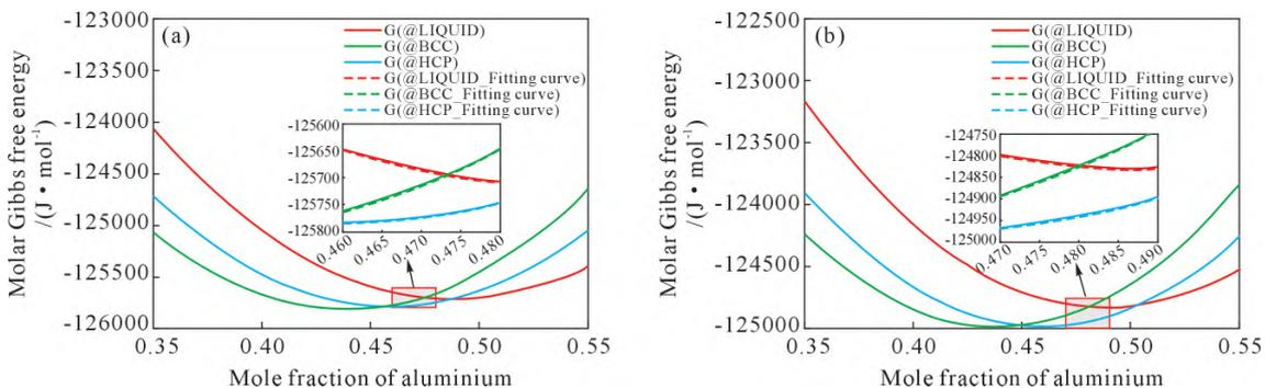
图2 Ti-Al 合金不同温度下各相吉布斯自由能曲线:(a) 1760 K; (b) 1750 K
