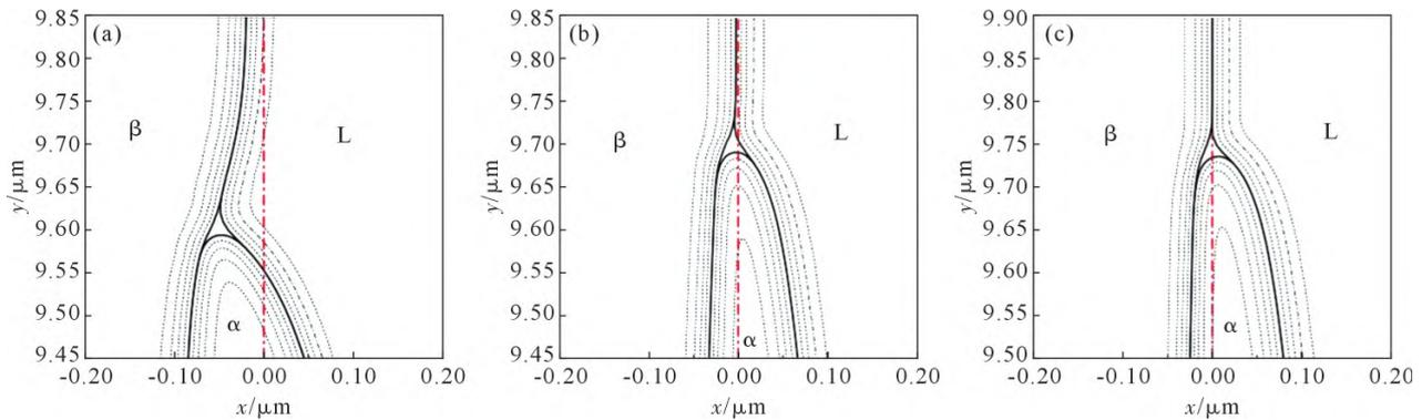
图8 不同过冷度条件下包晶反应三相区附近界面形貌:(a)  $\Delta T=3$  K; (b)  $\Delta T=5$  K; (c)  $\Delta T=10$  K
