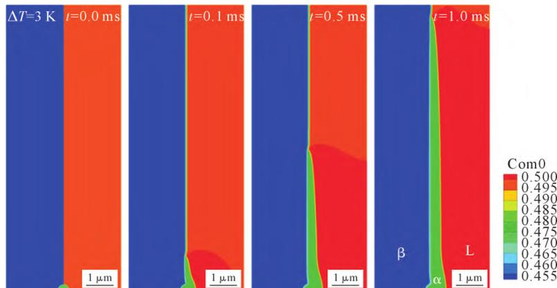
图7  $T=1760.9\text{ K}$  下  $\alpha$  片层生长时的溶质分布
