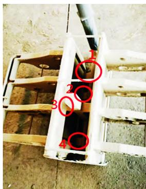
图9 连杆架最终工艺(侧面4点进液)
