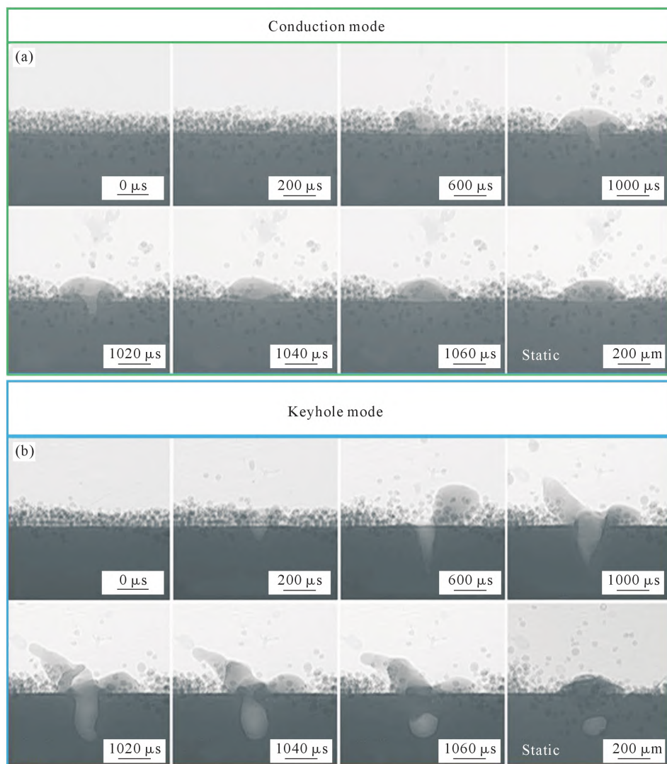
图5 Ti-6Al-4V 激光粉末床熔融过程中匙孔模式衍变的动态 X 射线图像:(a) 传导模式,(b) 匙孔模式 [5]
