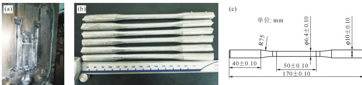
图 1 实验样品图:(a) 试棒压铸模具,(b) 压铸试样,(c) 试棒尺寸
