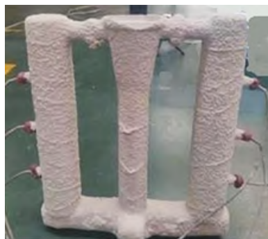
图7 热电偶的位置示意图 Fig.7 Location diagram of the thermocouples
