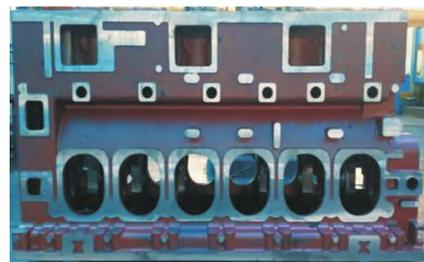
图8 调试加工后无缺陷
