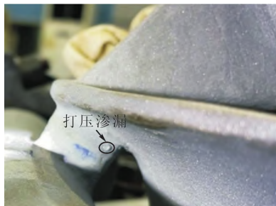
图 2 机匣打压渗漏
