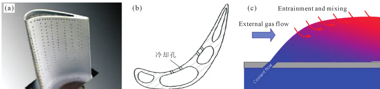
图 1 航空发动机涡轮叶片:(a) 气膜孔分布,(b) 叶片剖面,(c) 气膜冷却原理 [6-7]
