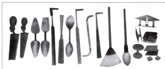
图中从左至右依次为: 1.刮刀 2.尖刮刀 3.压勾 4.单齐压勾 5.提钩 6.单头钢批 7.秋叶 8.单开提钩 9.法兰钩 10.钢批钩 11.掸笔、扫笔 12.圆水笔 13.铸顶
