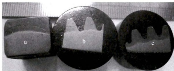
图1 齿面裂纹形貌和淬硬层深度
