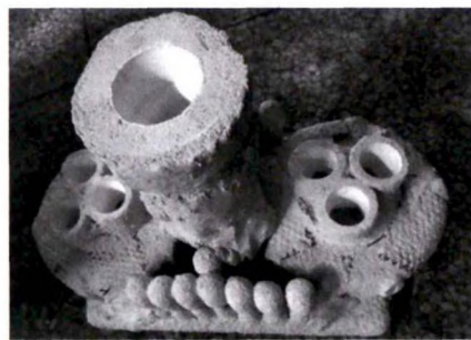
图2 钛合金叶轮焙烧后型壳
