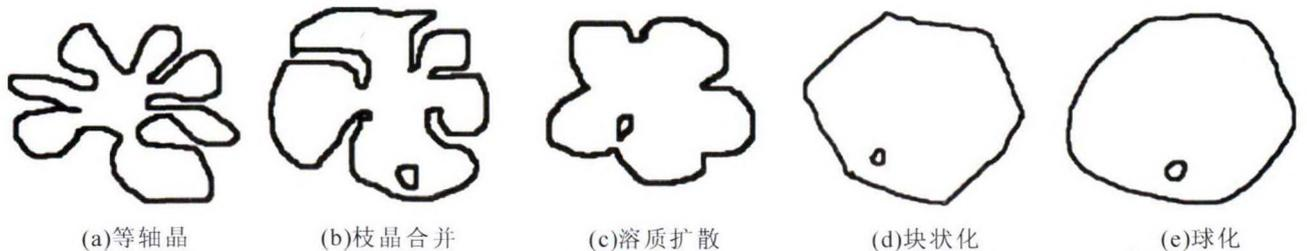
图5 细小等轴晶在半固态等温热处理过程中的演变示意图
