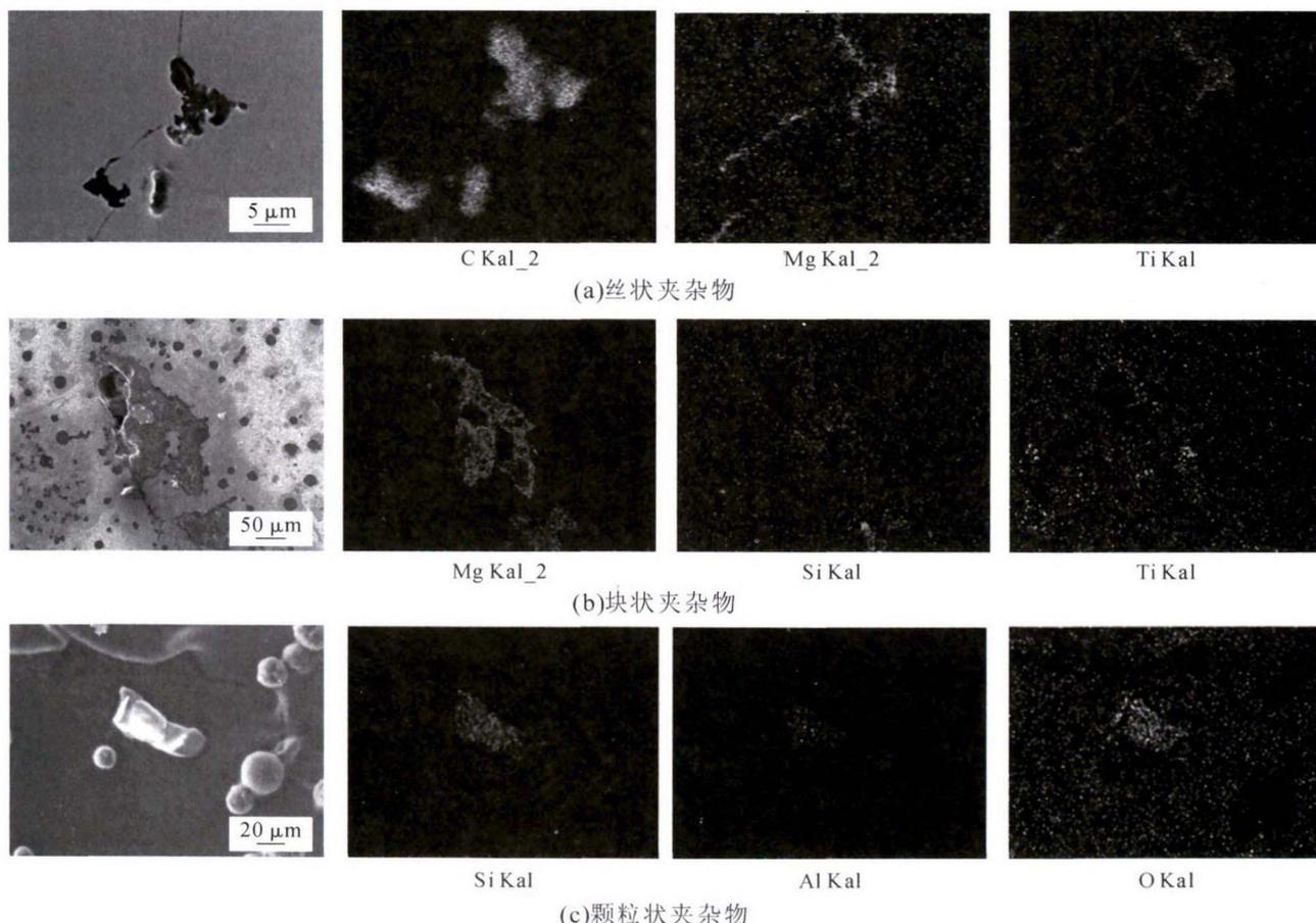
图 6 典型夹杂物化学元素分布的 EMPA 图片
