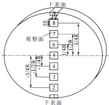
图 1 型材试样截取示意图
