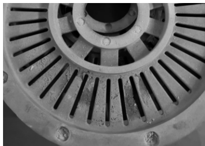
图 5 局部缺砂的制动盘砂芯 Fig.5 Local sand-deficient brake disc sand core
