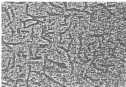
图 5 未加 sic 试样石墨形态 或 (未加 sic 试样) Fig.5 Without SiC sample
