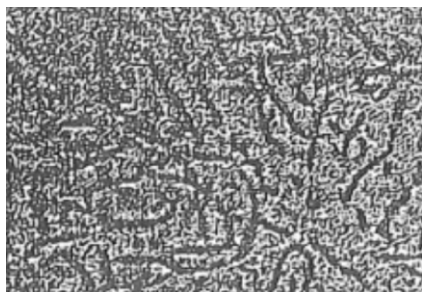
图 6 加 sic 试样石墨形态 或 (加 sic 试样) Fig.6 Add SiC sample
