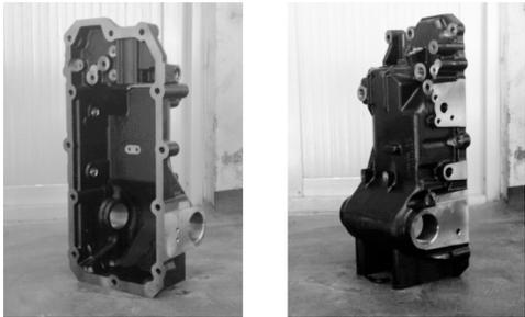
图3 拖拉机升降器液压壳盖零件
