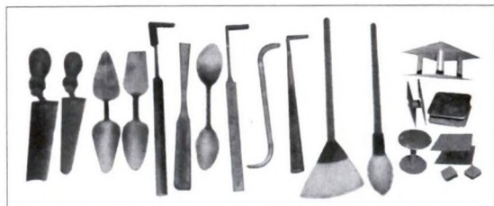
图中从左至右依次为: 1.刮刀 2.尖刮刀 3.压勺 4.单齐压勺 5.提钩 6.单头钢批 7.秋叶 8.单开提钩 9.法兰钩 10.钢批钩 11.掸笔、扫笔 12.圆水笔 13.铸顶
