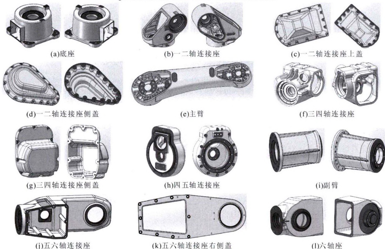
图2 启帆 STS 关节型 SRD6-1400 六轴工业机器人铸件三维模型 Fig.2 3D module castings of STS articular SRD6-1400 Six axis industrial robot
