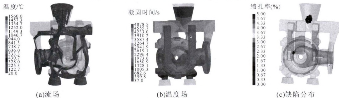
图6 优化后铸件模拟结果 Fig.6 Optimized casting simulation results
