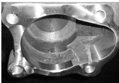
图 8 优化工艺后组焊到车体上的铸件
