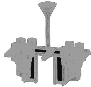
图 6 优化工艺后三维模型网格化
