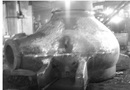
图 8 精整后的铸件
