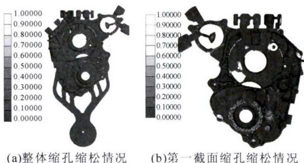
图 13 铸件缩孔缩松情况
