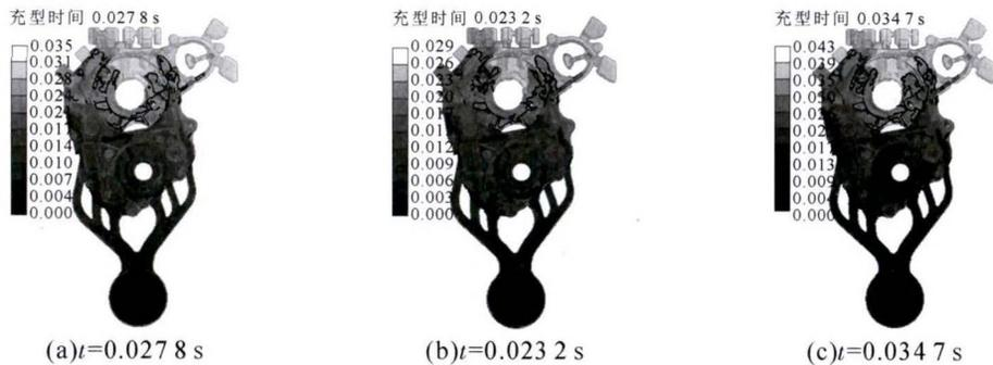
图4 铸件填充80%的充型过程
