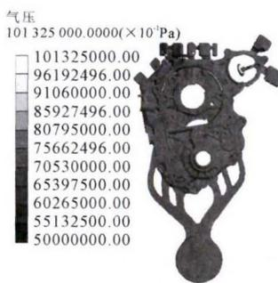
图 16 铸件空气压力分布
