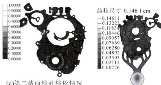
图 14 铸件晶粒尺寸分布
