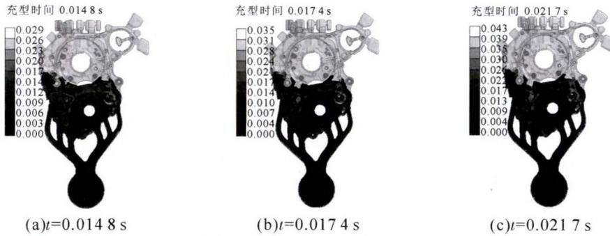
图3 铸件填充50%的充型过程
