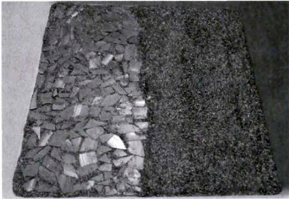
图 1 籽晶铺设方法 Fig.1 Laying methods of seed crystal
