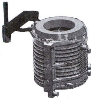
图 1 电机壳分型面在铸件端面
