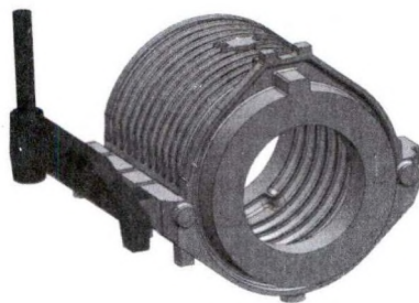
图 2 电机壳分型面在铸件中间
