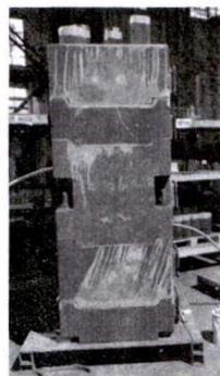
图3 砂芯组合并使用螺杆固定
