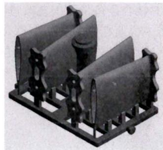
图 5 浇注系统三维图
