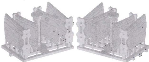
图 10 充型结束时刻粒子分布图( $n=210$  r/min)
