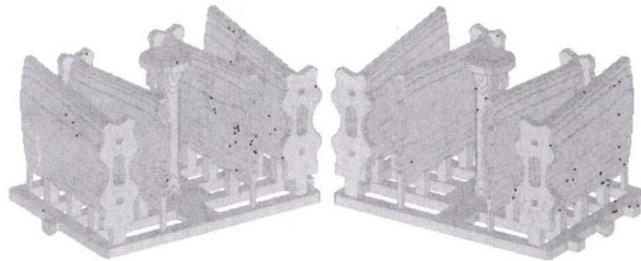
图 11 充型结束时刻粒子分布图( $n=240$  r/min)
