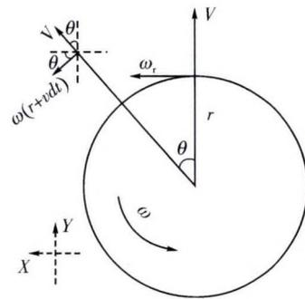
图 2 旋转坐标系速度图
