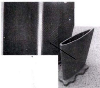
图7 试制铸件及夹杂扫描结果
