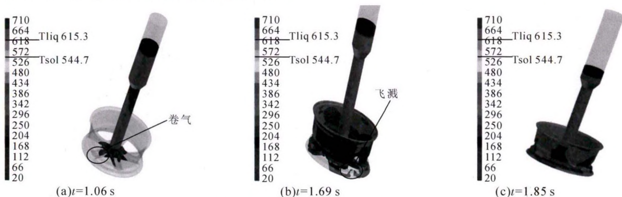
图2 不同浇注时间下充型过程的温度场
