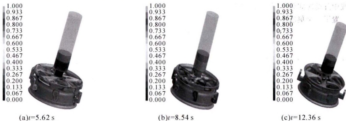
图7 优化后不同时间下凝固过程固相率
