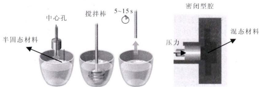
图3 半固态成形原理结构图
