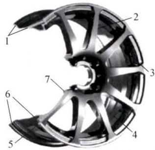
1- 轮辋;2- 轮辐;3- 气门孔;4- 槽底;5- 轮缘;6- 胎圈座;7- 偏距
