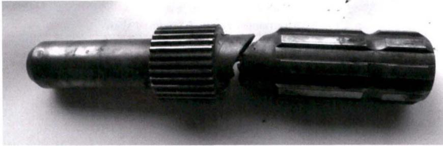
图1 断裂的动力输出轴
