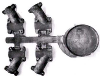
图7 最优参数压铸的铸件 Fig.7 Casting with optimum parameters of die casting
