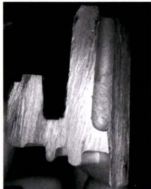
图 14 优化后壳体内部质量 Fig.14 Internal quantity after optimization 组织致密,未发现气、缩孔缺陷,产品强度满足了使用要求。
