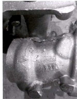
图2 铸件次高点附近气孔缺陷
