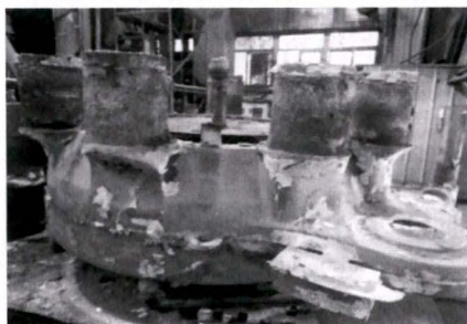
图 7 左右法兰铸件,冒口及补贴切割痕迹
