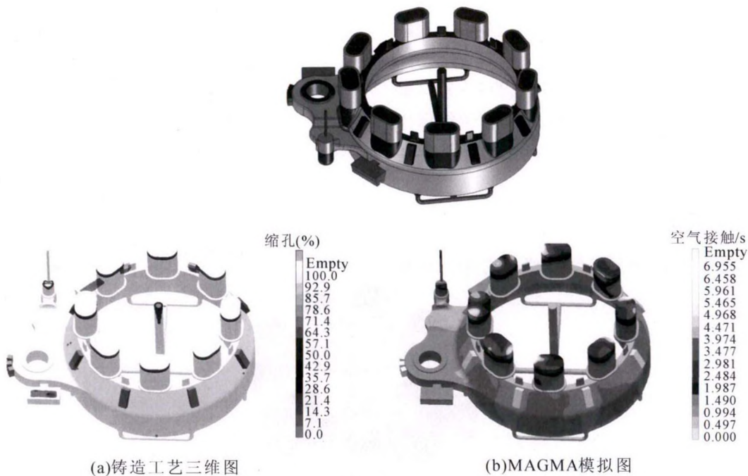
图3 左右法兰铸钢件铸造工艺三维图,MAGMA 模拟图
